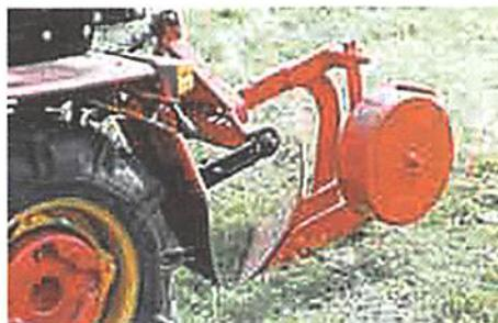
1. Перемещением плуга относительно сцепки в вертикальной плоскости.
